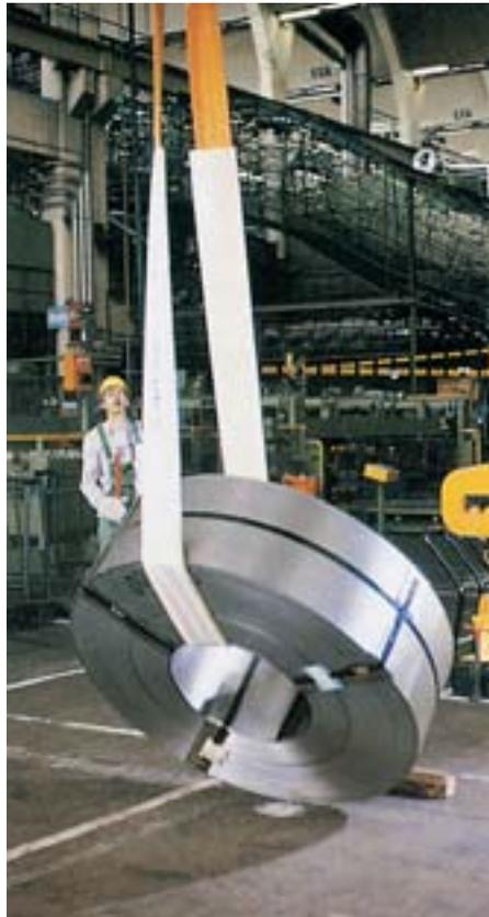
Rundschlingen mit Kantenschutzschlauch sind nur zum Heben, nicht jedoch zum Wenden geeignet, im Kantebereich entsteht zu viel Wärme.
