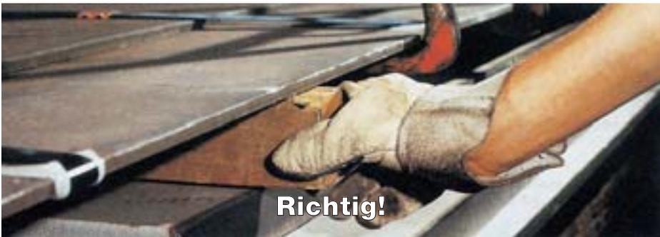
darf man sich nie zwischen der bewegten Last und festen Teilen aufhalten. Denn auch in einer von Hand in Bewegung gebrachten Last steckt so viel Energie, dass die Last nicht auf der Stelle durch Körperkraft abgestoppt werden kann.
