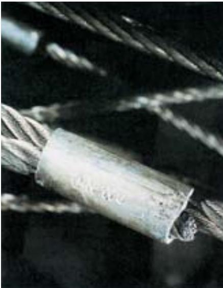
Spleiß. Deshalb muss das Drehen der Last verhindert werden. Seilendverbindungen durch Knoten herzustellen ist nicht zulässig, da die Tragfähigkeit des Seiles durch hohe Flächenpressung und Knicke stark herabgesetzt wird (Bild 9-2). Die Litzen und Drähte werden so gestaucht, dass der Seilverbund nicht mehr gewährleistet ist.
