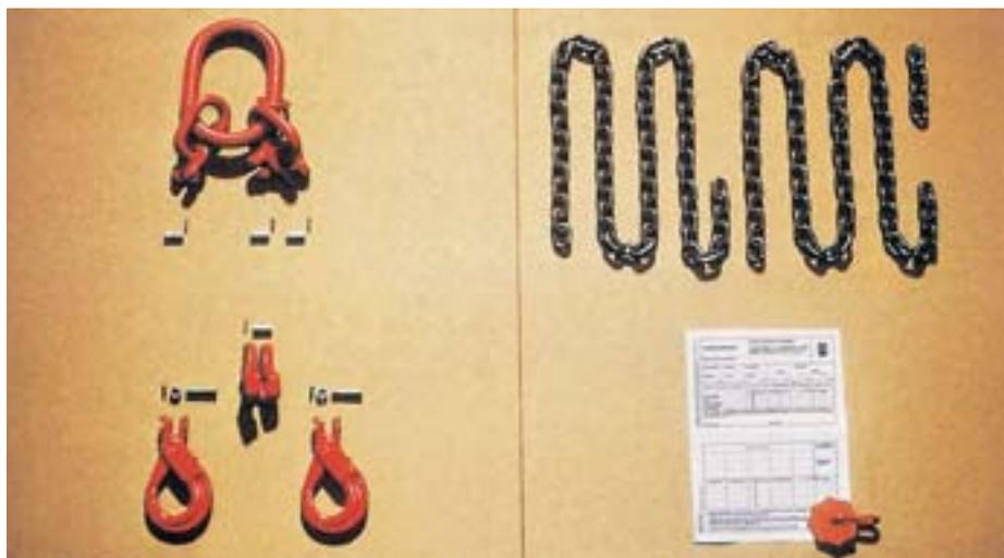
Für die Güteklasse 8 gibt es Bauteilserien, die eine eindeutige Zuordnung von Ketten-Nennstärke und Bauteil mit gleicher Tragfähigkeit gewährleisten. Die Öffnung am Bauteil ist zu schmal für eine zu dicke Kette, der Bolzen zu dick für eine zu dünne Kette.
