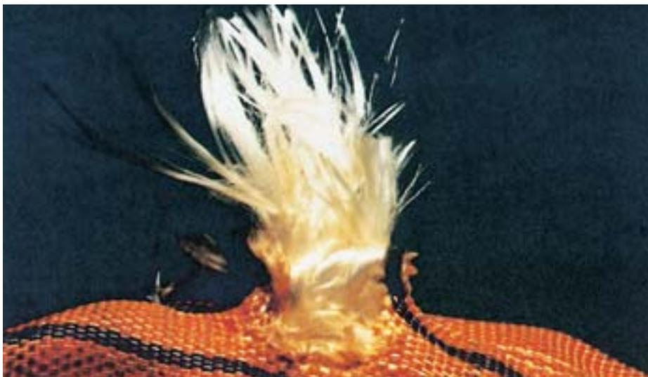
Bild 23-16: Durch Wärmeeinfluss zerstörte Ummantelung
