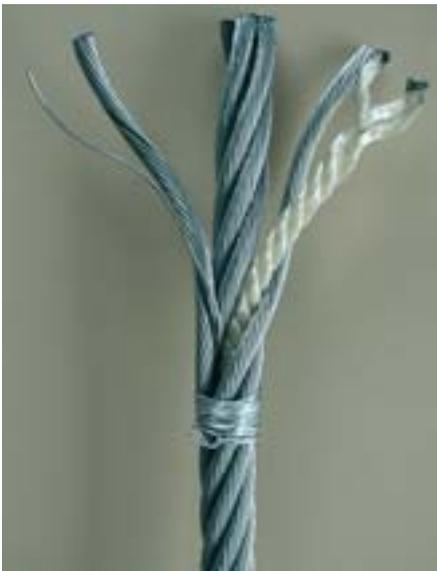
Es besteht aus mehreren Litzenseilen, die ihrerseits wieder zu einem Seil gefügt sind. Man erkennt Kabelschlagseile bereits von außen an der Feingliedrigkeit der einzelnen Litzen.
