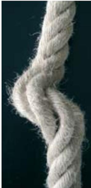
*Bild 23-9: Wärmeeinfluss hat eine Litze zerstört*
