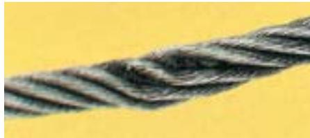
*Bild 23-4: Kinke/Klanke und Eindrückung einer Litze. Der Seilverbund ist zerstört: Ablegen!*
