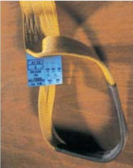
Sie verbinden Licht- und Wärmestabilisierung, gute Beständigkeit gegen die meisten Säuren und Lösemittel mit einem hohen Elastizitätsmodul. Polyester ist der am häufigsten verwendete Werkstoff. Nur beim Einsatz in Laugen ist er nicht so beständig und sollte deshalb auch nicht mit Seife, sondern mit schonenden Haushaltswaschmitteln gewaschen werden.
