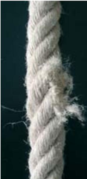
*Bild 23-8: Durch Klanke zerstörter Litzenverbund*
