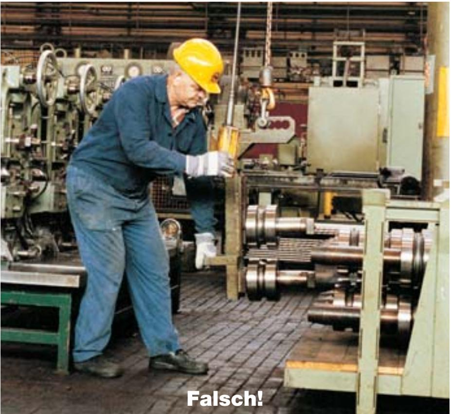
*Bild 5-24: Der Kranführer befindet sich hinter der Last und bremst die Fahr- und Schwenkbewegung ziehend ab*
