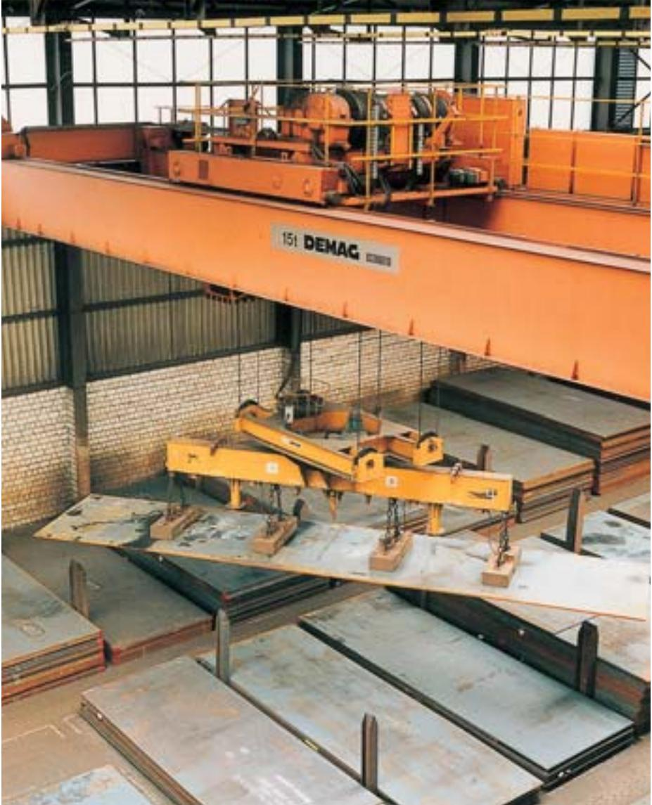
Kraftschlüssig angeschlagene Lasten dürfen nicht ohne zusätzliche Sicherung über Personen hinweg befördert werden. Der Einsatz von Stützbatterien ist keine zusätzliche Sicherung. Als zusätzliche Sicherung können mechanische Einrichtungen, welche die Last beim Versagen der kraftschlüssigen Lastaufnahme
