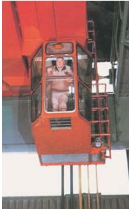
*Bild 3-9: Der Ablöser gibt dem Kranführer Signal, dass er den Kran betreten will. Der Ablöser muss warten, bis durch Lichtzeichen Einverständnis gegeben wird*
