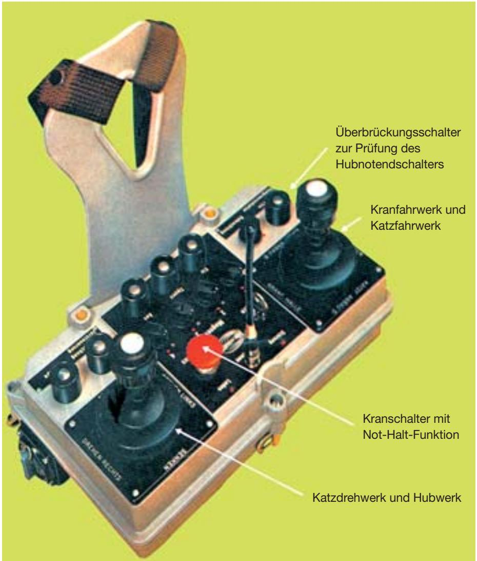
Bei flurgesteuerten Kranen können die **Kran- und Katzfahrrichtungen** nicht sinnfälligerweise den zugehörigen Stellteilen der Flursteuerungseinrichtung oder des Fernbedie-
