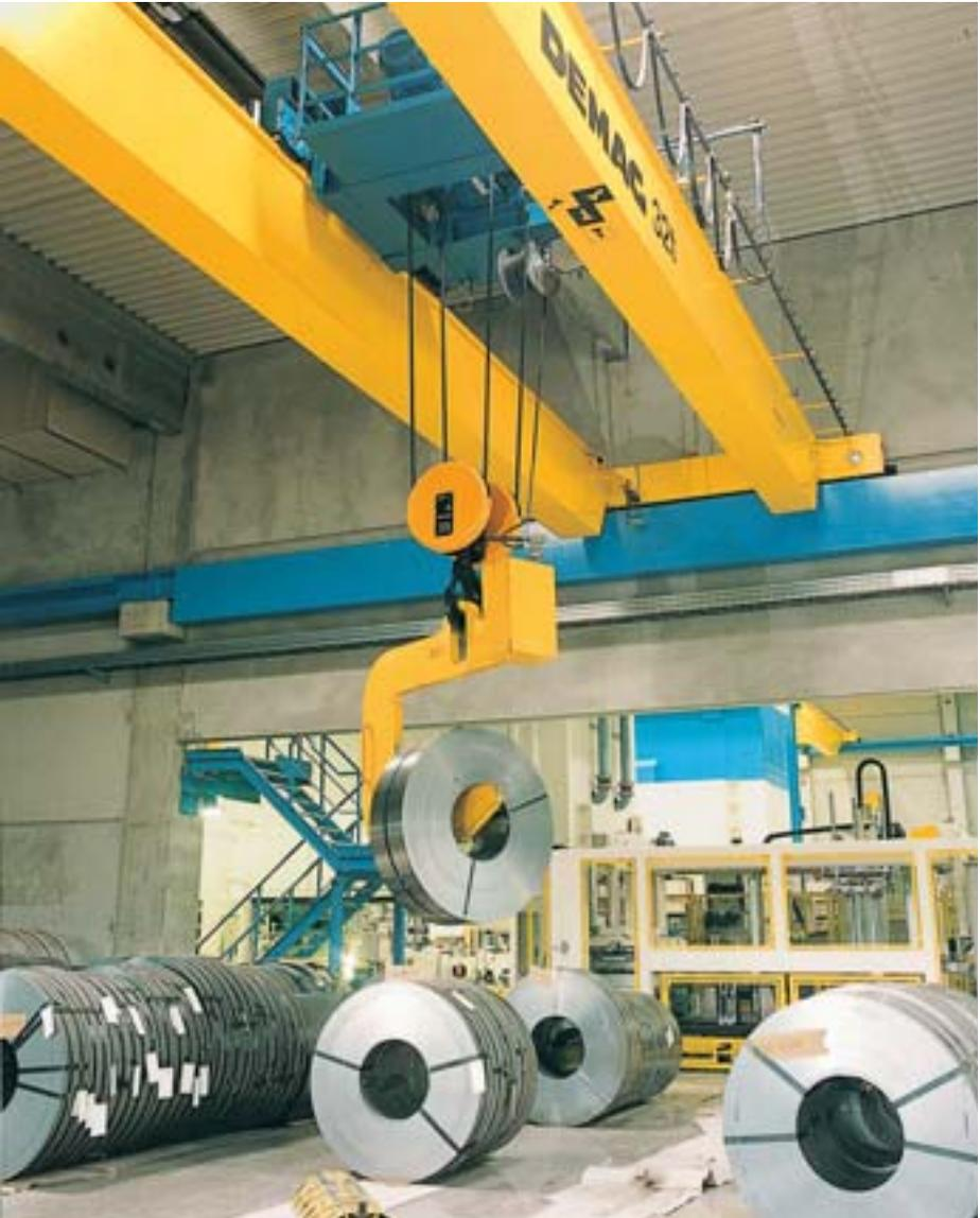
Bild 5-9: Motorisch angetriebener Greifer
