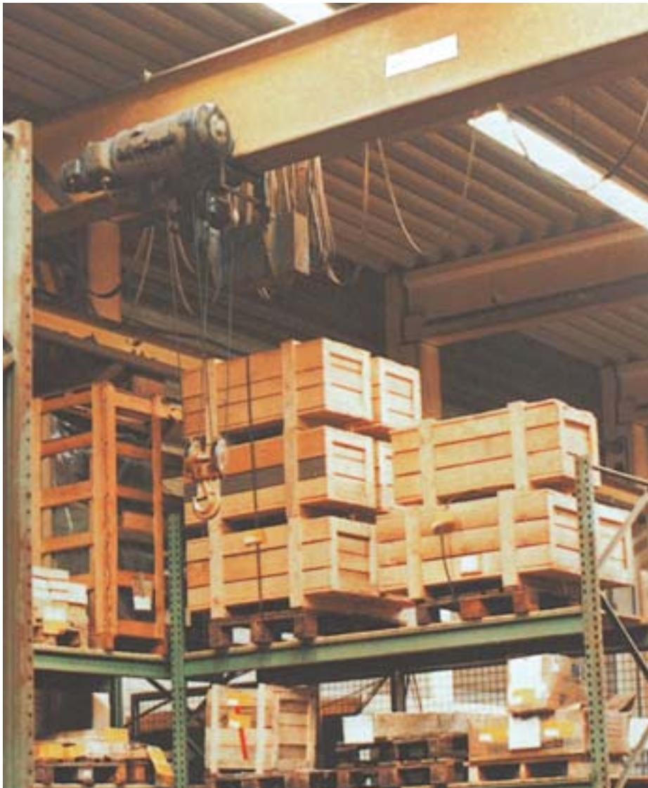
Bild 4-8: Es besteht **Quetschgefahr**. Der Kranführer erkennt dies rechtzeitig, wenn er vor Arbeitsbeginn einen Blick längs der Kranbahn wirft
