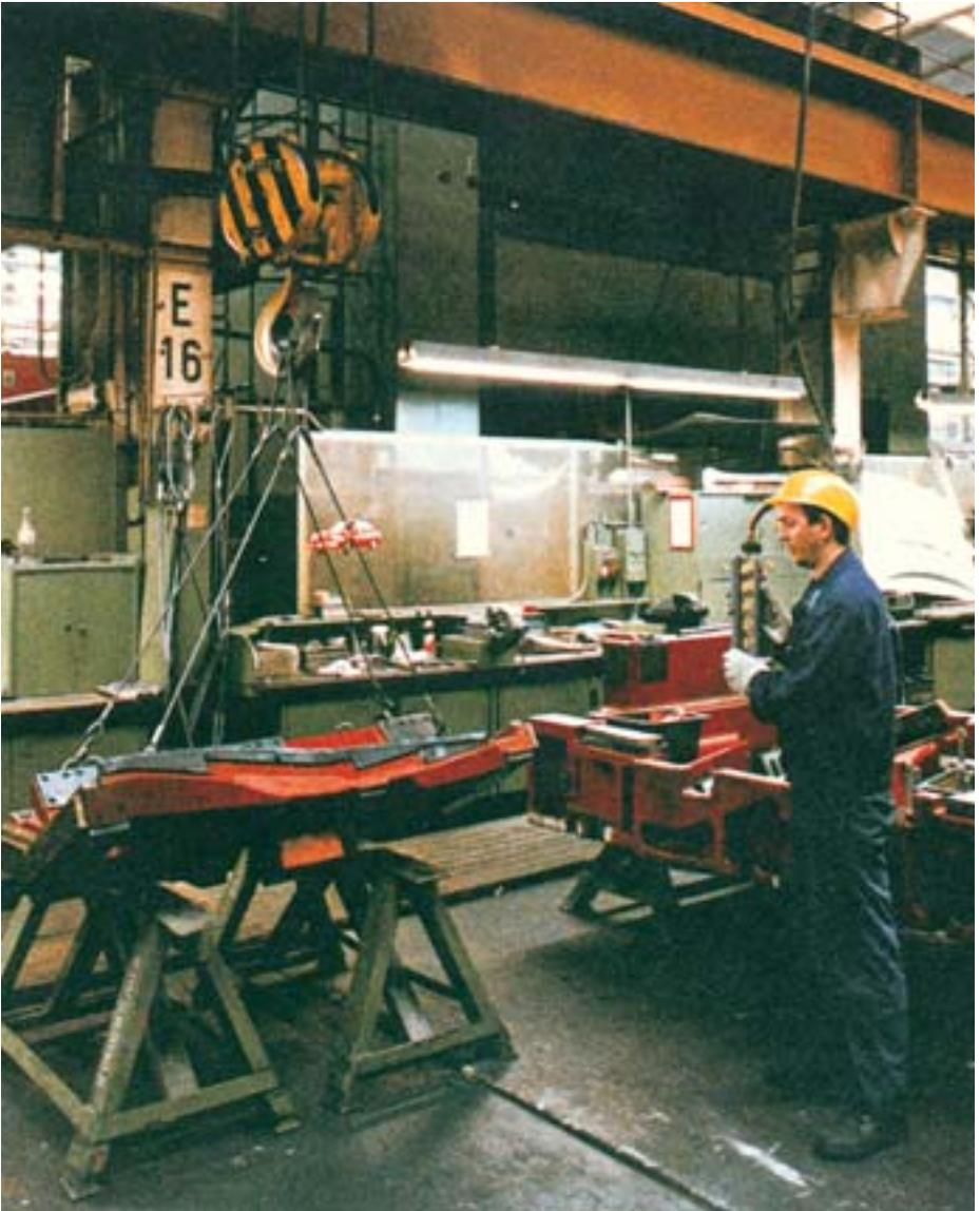
Die **kabellose Steuerung** lässt zu, dass der Kranführer dem Kran in einer angemessen sicheren Entfernung folgt und steuert. Dies wird besonders wichtig, wenn z. B. feuerflüssige Massen, glühende Schmiedeteile oder Lasten, die durch Kraftschluss (Magnete, Saugheber, Klemmen) gehalten werden, zu transportieren sind (Bilder 3-3 und 3-4).
