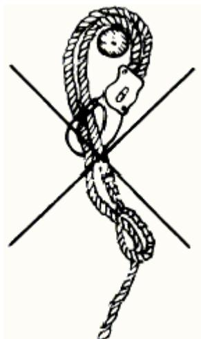
Bild 27: Falsches Anschlagen eines Seiles mit Falldämpfer
