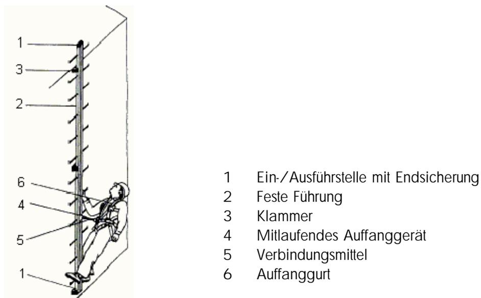
Bild 3: Skizze des Auffangsystems mit mitlaufendem Auffanggerät einschließlich fester Führung (Steigschutzeinrichtung)
