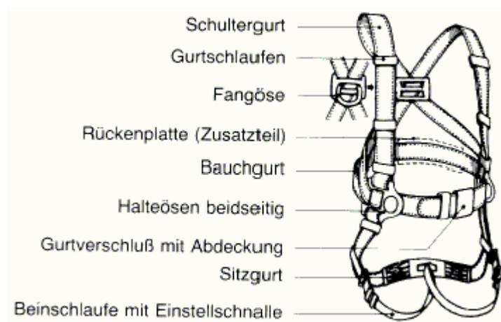
Bild 8: Auffanggurt mit rückseitiger Fangöse und seitlichen Halteösen
